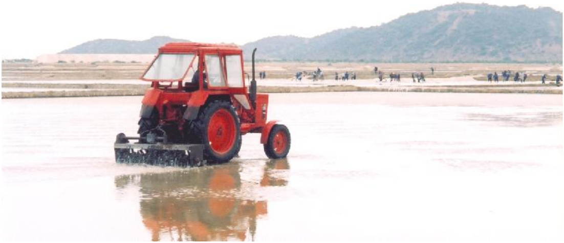
Hình 4.2: Phay muối trước khi thu gom
