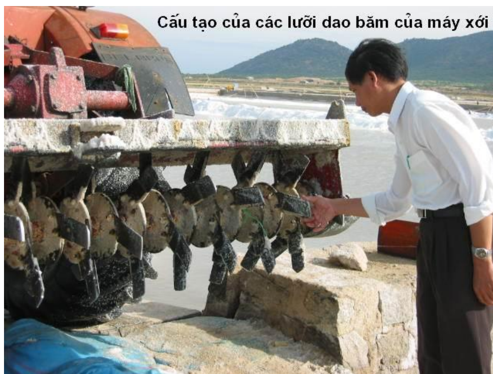
Hình 4.4: Máy kéo có gắn hệ thống dao băm để phá vỡ lớp muối
