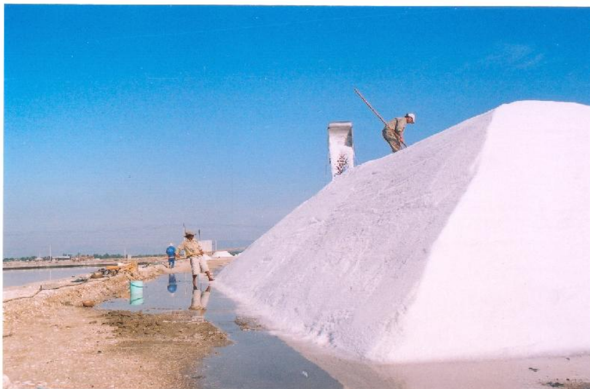
Hình 4.32: Đánh đồng muối thủ công kết hợp với cơ giới
