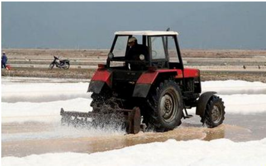
Hình 4.3: Phay muối trước khi thu gom
