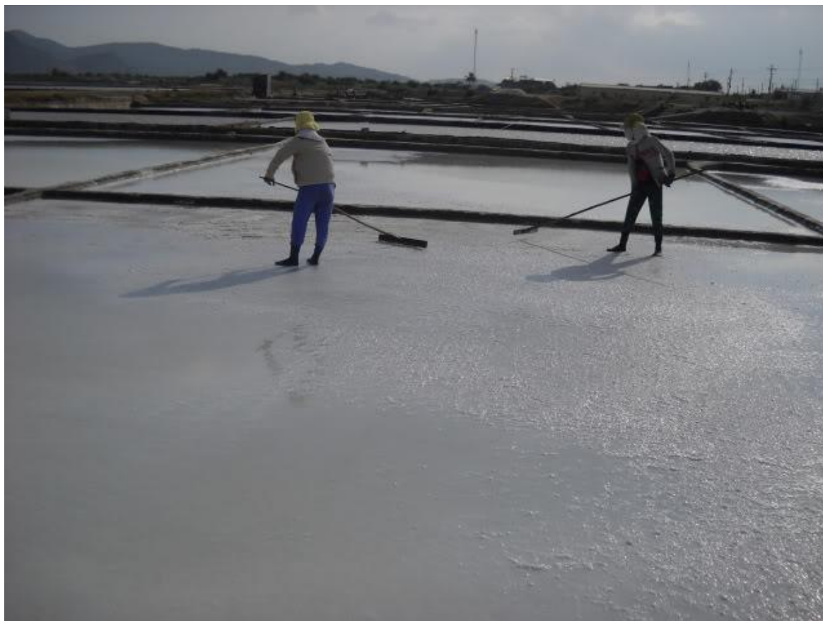
Hình 4.10: Bắt đầu dùng bàn cào muối vun muối kết tinh sẵn ngày
