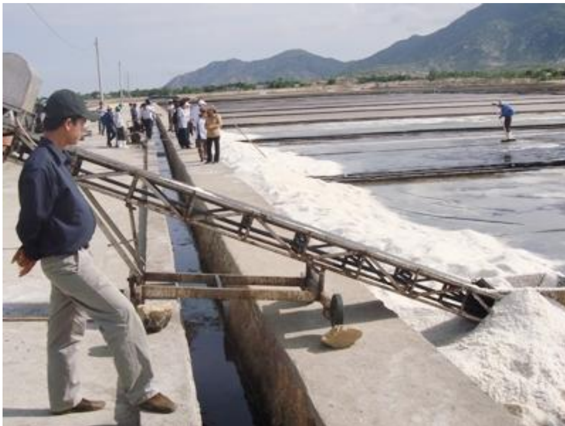
Hình 4.17: Gom muối lên phương tiện vận chuyển (xe tải đang đỗ ở trên đường)
