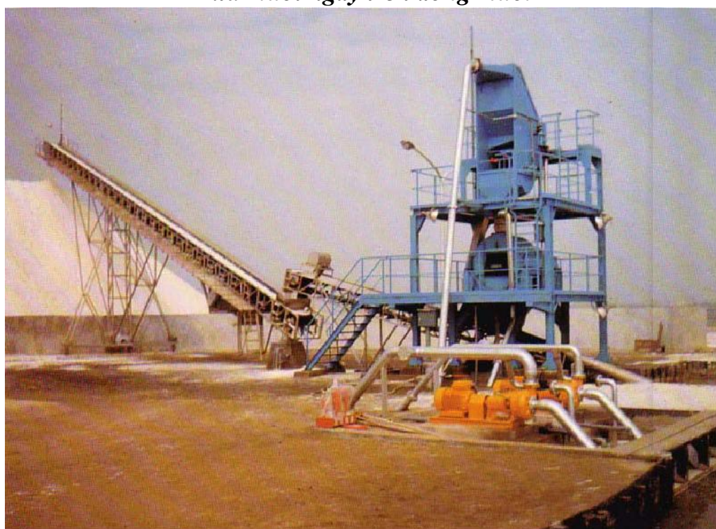
Hình 4.29: Thiết bị rửa muối dùng bơm rắn lỏng, máy ly tâm, sàng tĩnh
