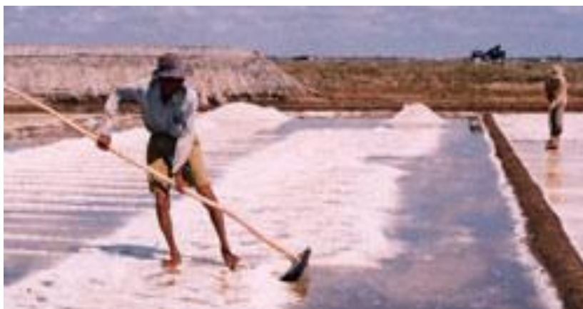
Hình 4.11: Dùng bàn cào muối vun muối kết tinh sẵn ngày
