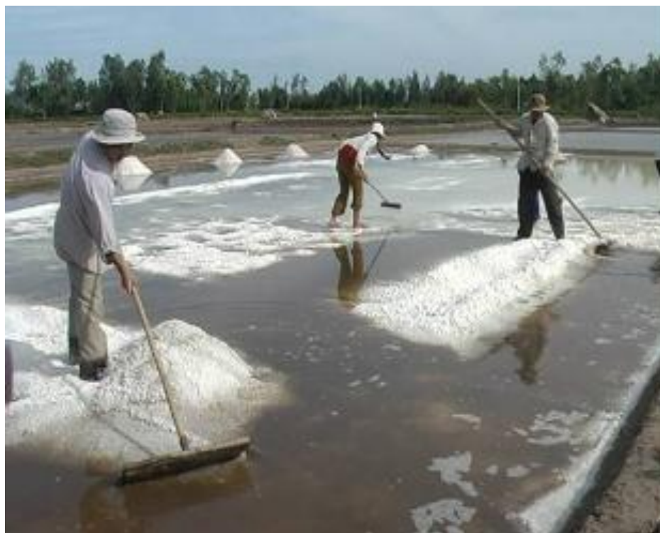
Hình 4.12: Dùng bàn cào muối vun muối kết tinh ngăn ngày
