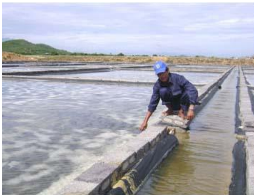
Hình 3.5: Mở phai đưa nước chạt vào khu kết tinh muối
