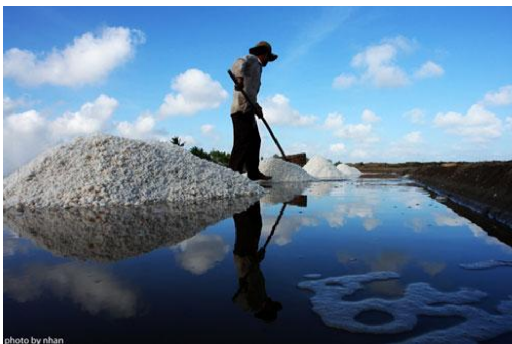
Hình 4.13: Dùng bàn cào muối vun muối kết tinh ngăn ngày
