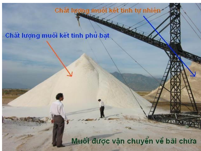
Hình 4.34: Để nâng muối lên tầm cao mới con người phải sử dụng đến băng tải
