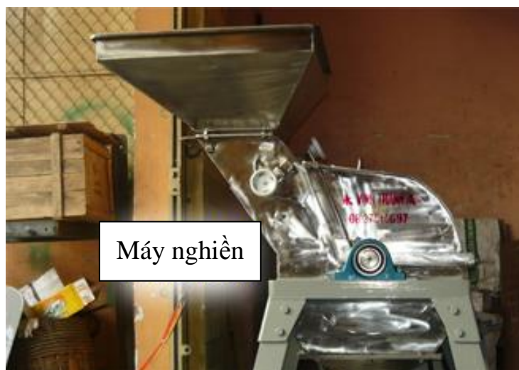
Hình 3.10: Một dạng máy nghiền tạo muối giống
