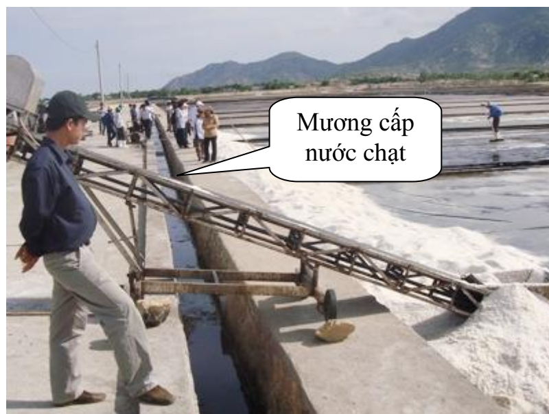
Hình 1.14: Mương cấp nước chạt cho ô kết tinh muối
