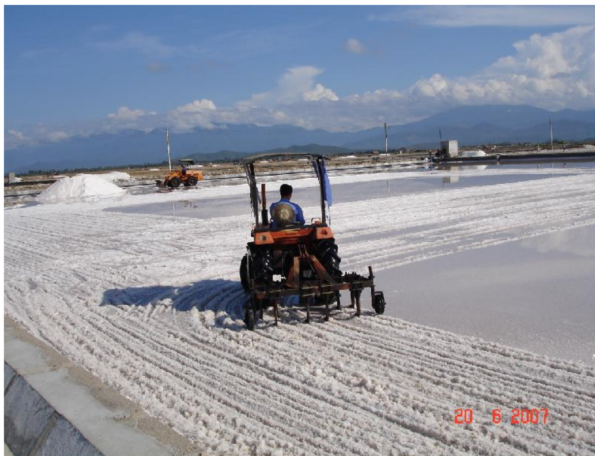
Hình 4.1: Dùng cày không lật phá vỡ lớp muối trên ô kết tinh
