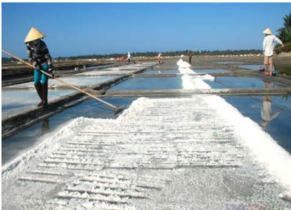
Hình 4.14: Dùng bàn cào muối đẩy muối kết tinh ngăn ngày
