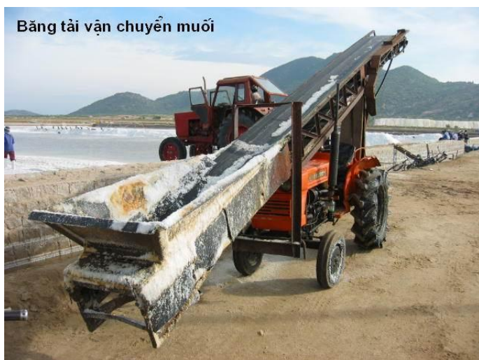
Hình 4.18: Băng tải di động giúp con người nâng muối lên tầm cao mới
