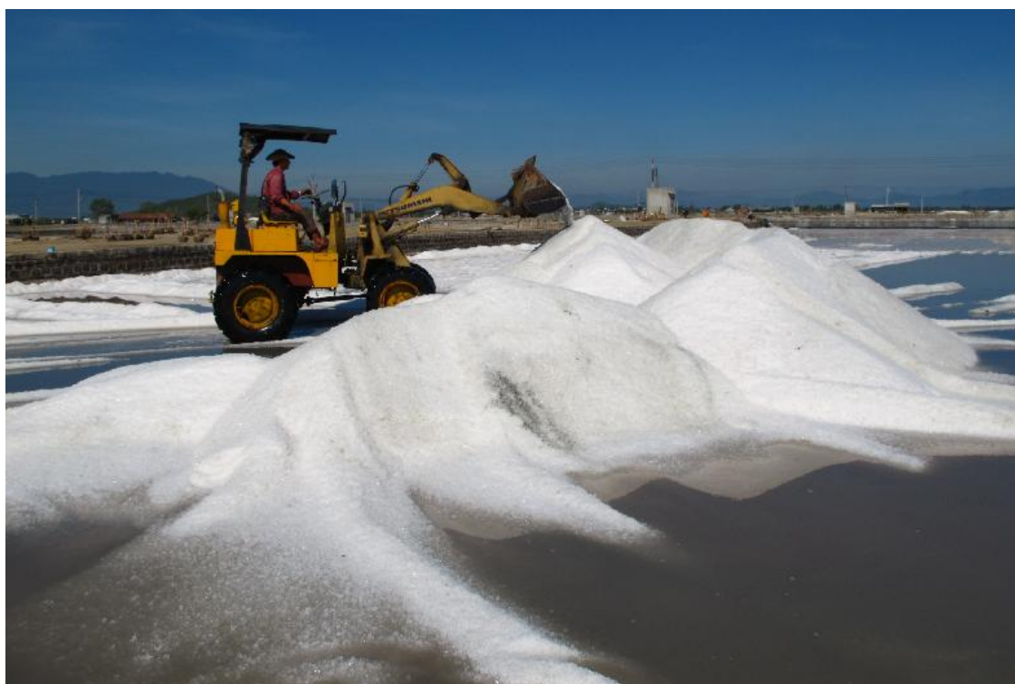
Hình 4.5: Vun muối bằng phương tiện cơ giới
