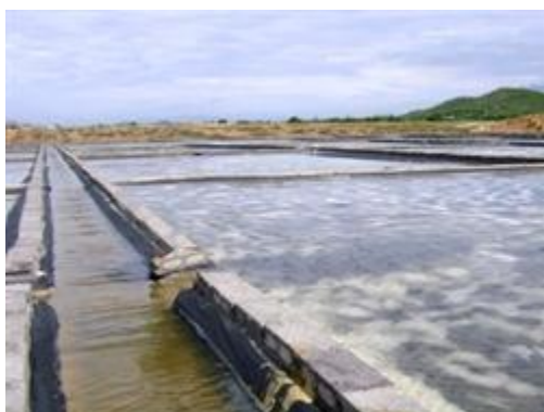
Hình 3.11: Khi cần chêm chạt: Mở phai để nước chạt bão hòa vào ô kết tinh muối, đủ chiều sâu nước đã định mới đóng phai
