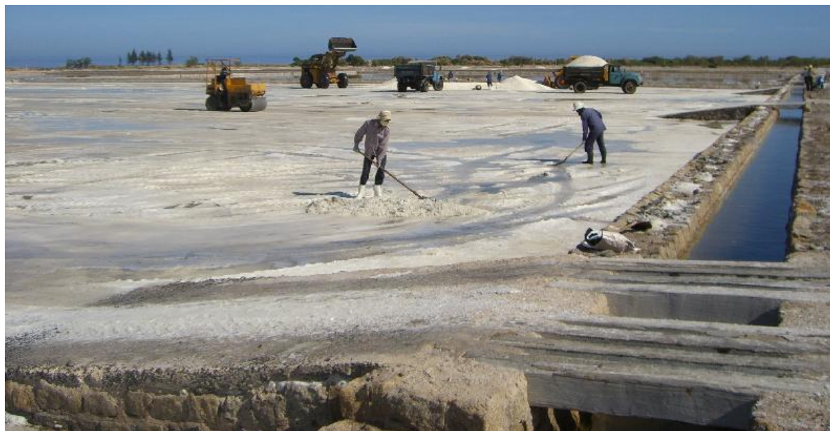
Hình 4.6: Vun muối bằng cơ giới kết hợp vun muối thủ công
