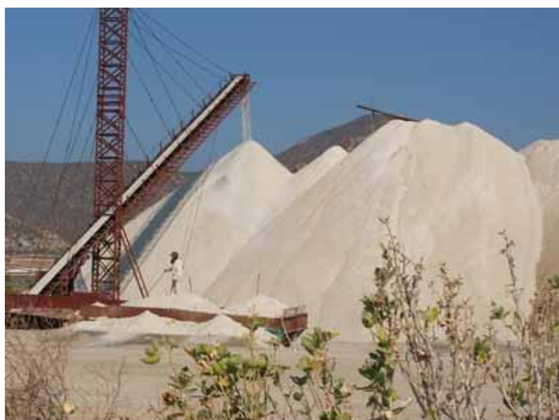
Hình 4.35: Để nâng muối lên tầm cao mới con người phải sử dụng đến băng tải
