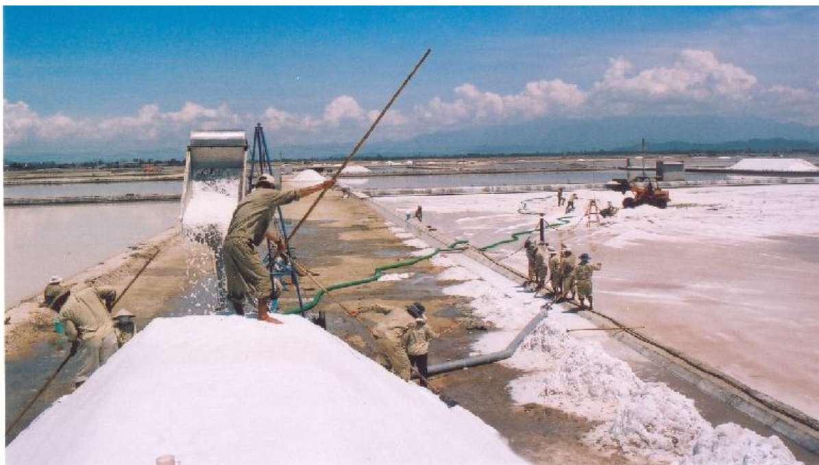
Hình 4.28: Bơm rắn lỏng vừa thu gom, vừa vận chuyển muối Rửa muối ngay trên đồng muối
